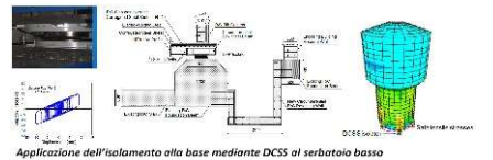
Applicazione dell'isolamento alla base mediante DCS al serbatoio basso
