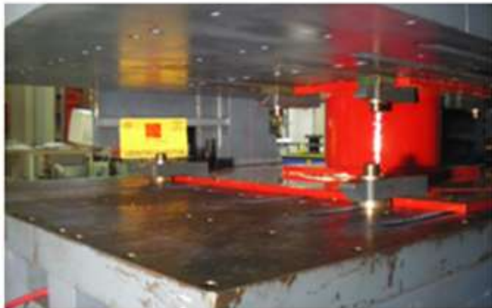
Dispositivo a scorrimento Acciaio – PTFE : Prova di qualificazione.
