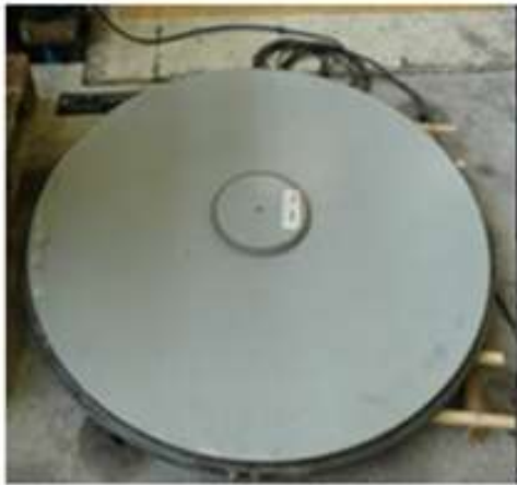
Isolatore a scorrimento Acciaio – PTFE
